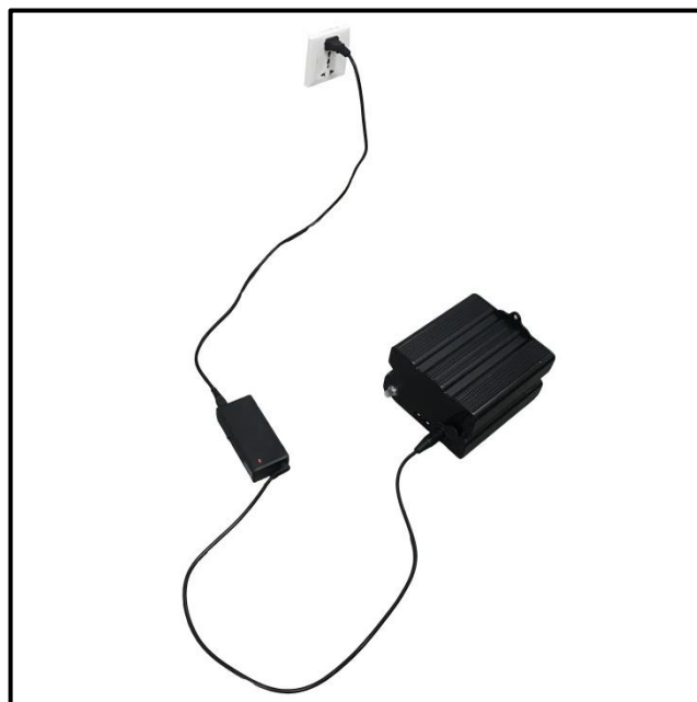
Figura 13. Carga de la batería con la caja de la batería
